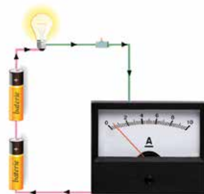
Figura 44 – Măsurare cu ampermetrul
