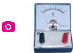
Figura 35 – Voltmetru de curen continuu
