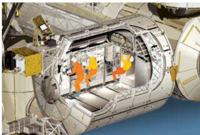
Figura 8 – Sistemul de întreținere a vieții și de control al mediului ambiant al ISS
